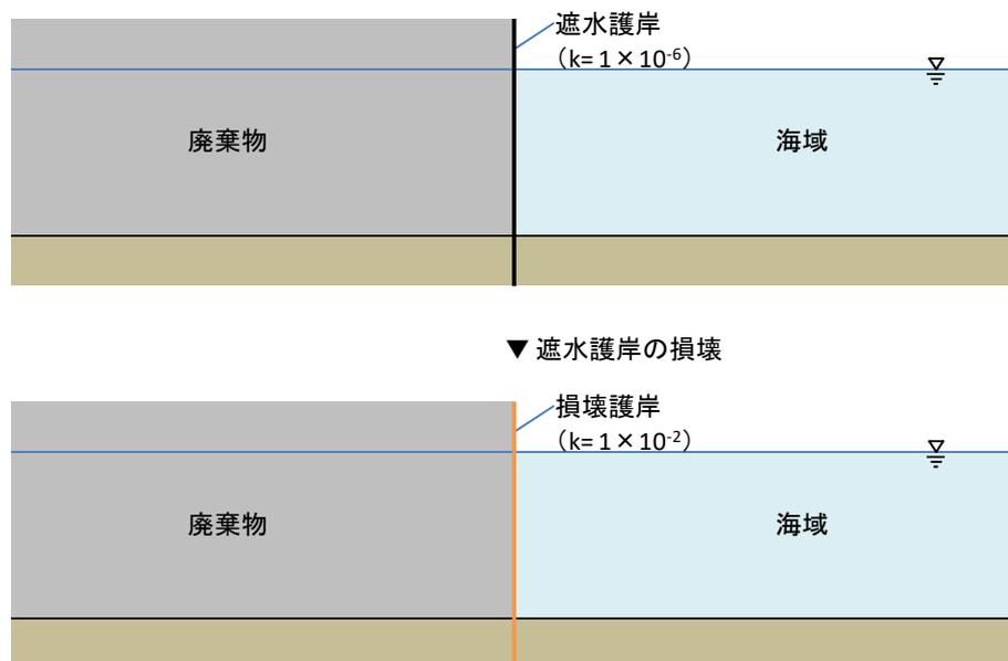
図 6.3 護岸 3 損壊時の計算条件
