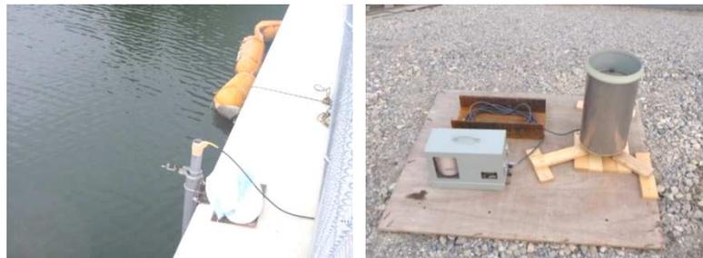
写真 5.1 現地水位観測の測器設置例（左：水位計，右：雨量計）
